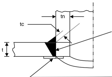
Soldadura de penetración completa; se debe considerar como prolongación de la pared del recipiente al determinar el área de ésta útil
