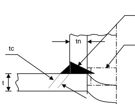
Soldadura de penetración completa; se debe considerar como prolongación de la pared de la boquilla al determinar el área de ésta útil como
