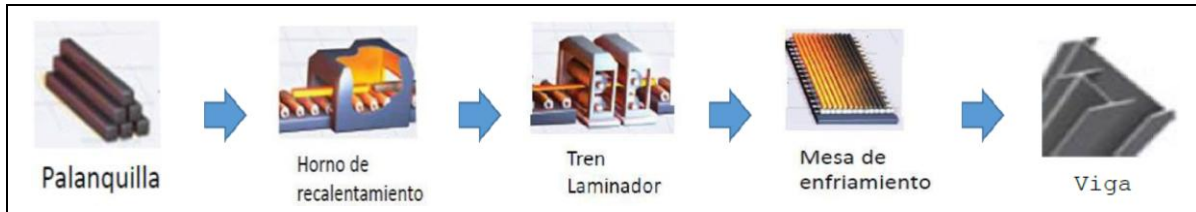
Diagrama del proceso de producción de vigas de acero
