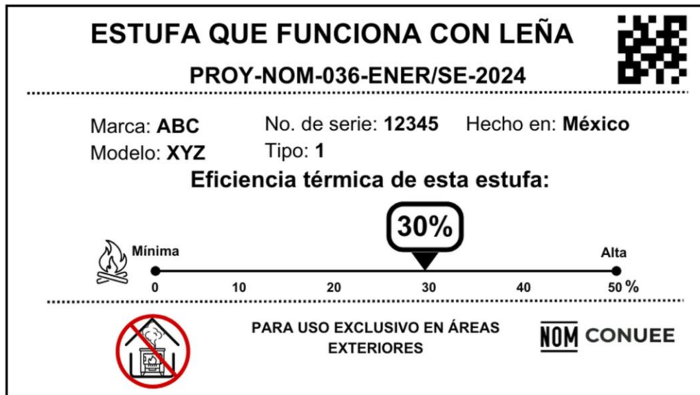
Figura 7 – Ejemplo de distribución de marcado para estufas que funcionan con leña con incumplimiento en la especificación de emisiones fugitivas
