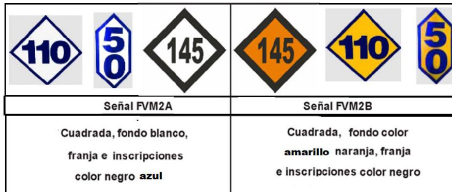
Figura 27 Señales FVM2A y FVM2B, velocidad máxima
