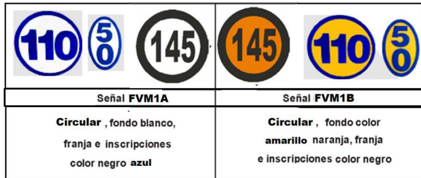
Figura 26 Señales FVM1A y FVM1B, anuncio de velocidad máxima.
