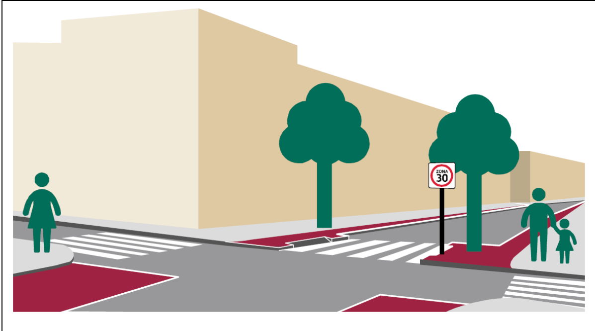
Figura 111.- Portal de acceso a zona de tránsito calmado [1] [2]
