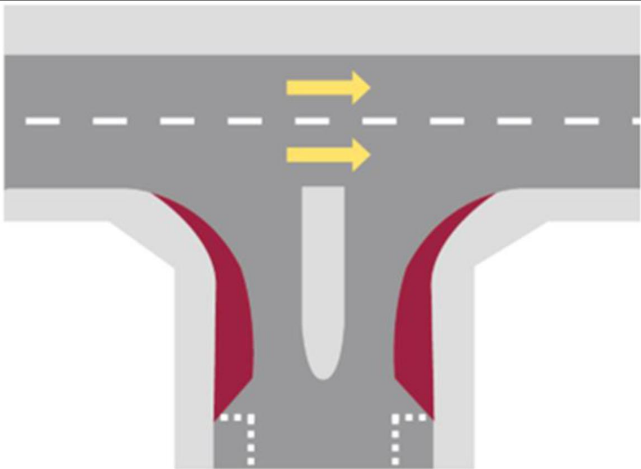
Variante 3, intersección en T con isla de protección peatonal central. (Definitiva)
