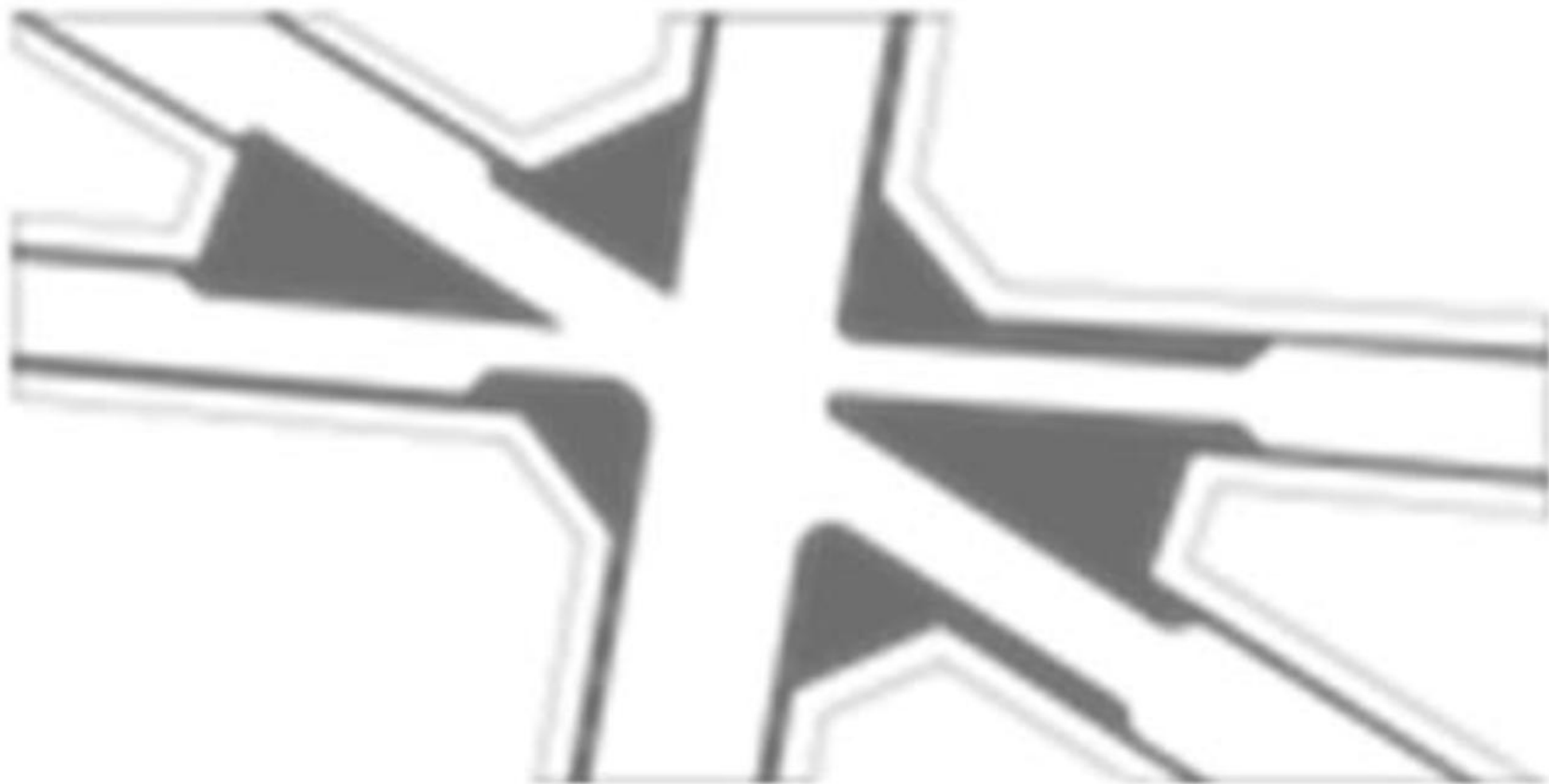
Figura 105.- Modificación geométrica en intersecciones [1] (PROY-NOM-004-SEDATU-2023)
